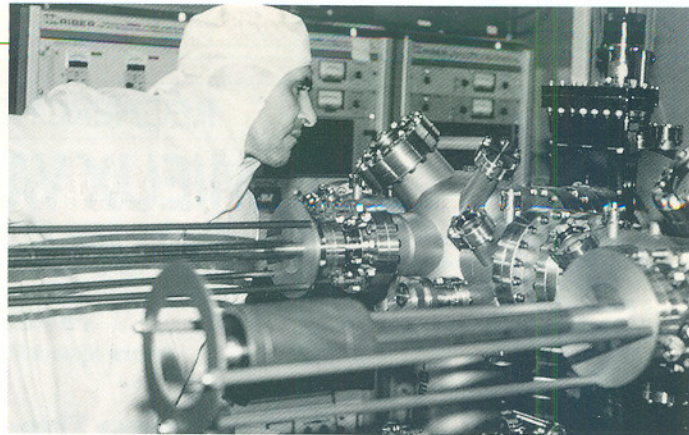
Epitaxie par jets moléculaires. Réalisation de couches semi-conductrices monoatomiques et d'hétérostructures complexes.
