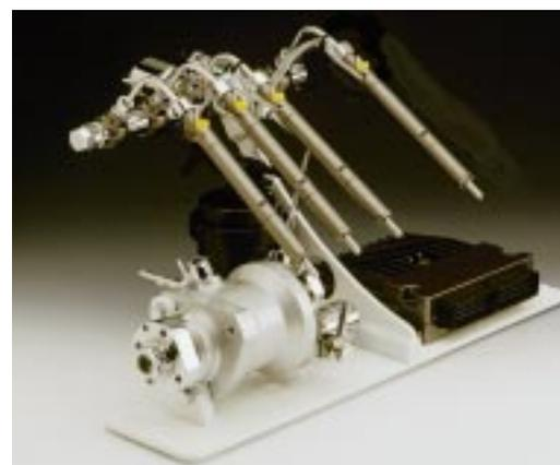
↑ Système d'injection diesel "Common Rail".
